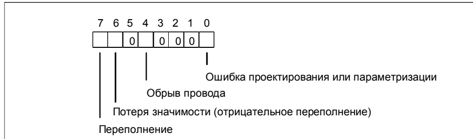
Рис. В–22. Четный диагностический байт для канала SM 431; AI 8 x RTD x 16 Bit
