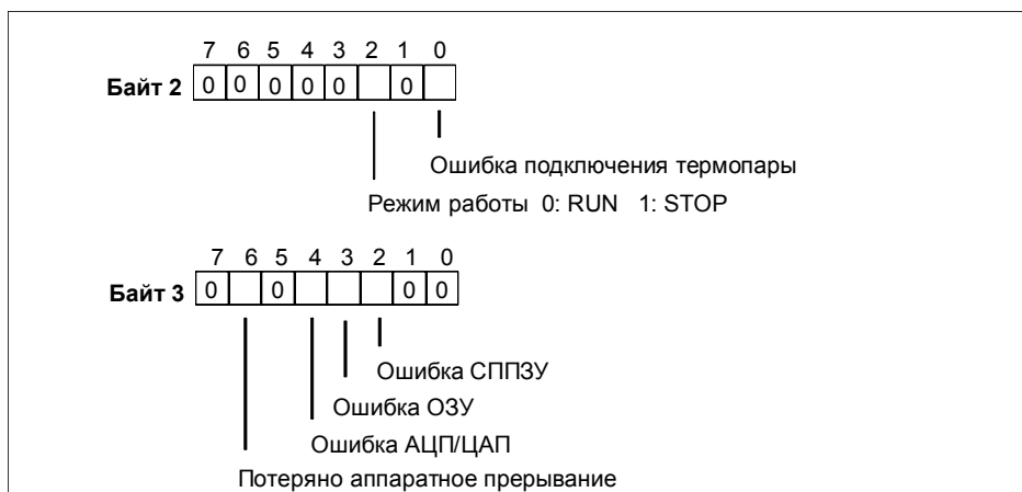
Рис. В-24. Байты 2 и 3 диагностических данных SM 431; AI 8 x 16 Bit
