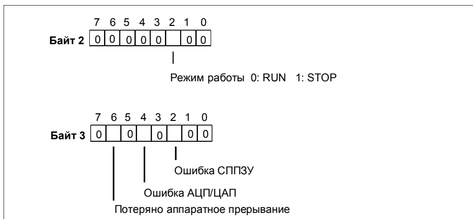
Рис. В-20. Байты 2 и 3 диагностических данных SM 431; AI 8 x RTD x 16 Bit
