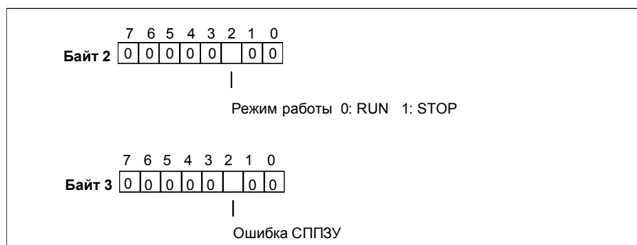
Рис. В-14. Байты 2 и 3 диагностических данных SM 422; DO 16 x 20–120 VAC/2 A
