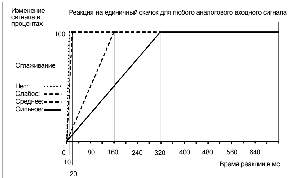
Рис. 5—46. Реакция на единичный скачок SM 431; AI 8 x 16 Bit при подавлении частоты помех 400 Гц
