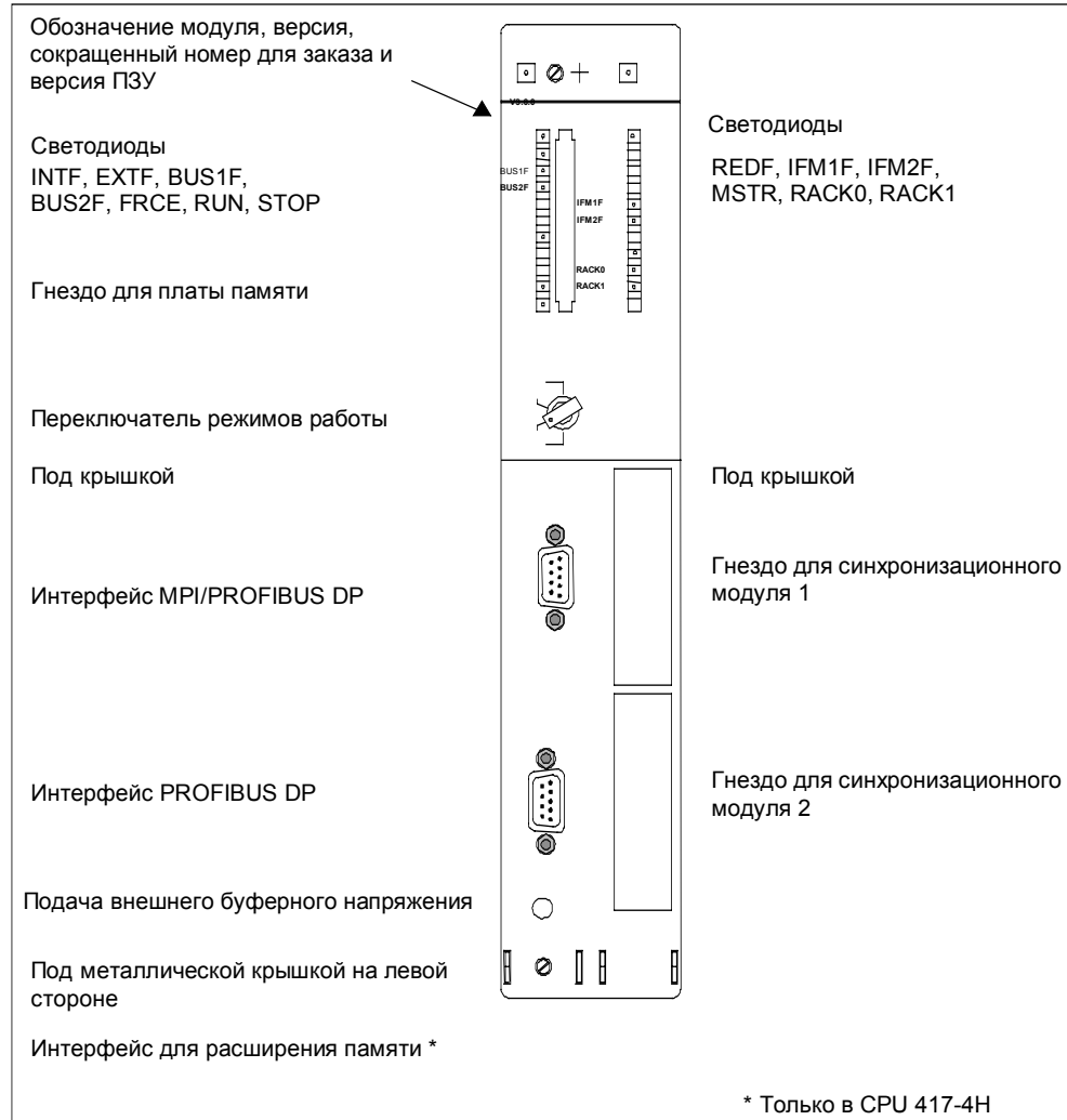
Рис. 4-1. Расположение элементов управления и индикации на CPU 414-4H/417-4H
