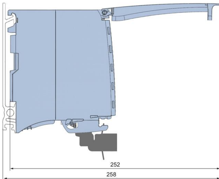
Рисунок А-2 Габаритный чертеж модуля AI 8xU/I HS, вид сбоку с открытой передней панелью
