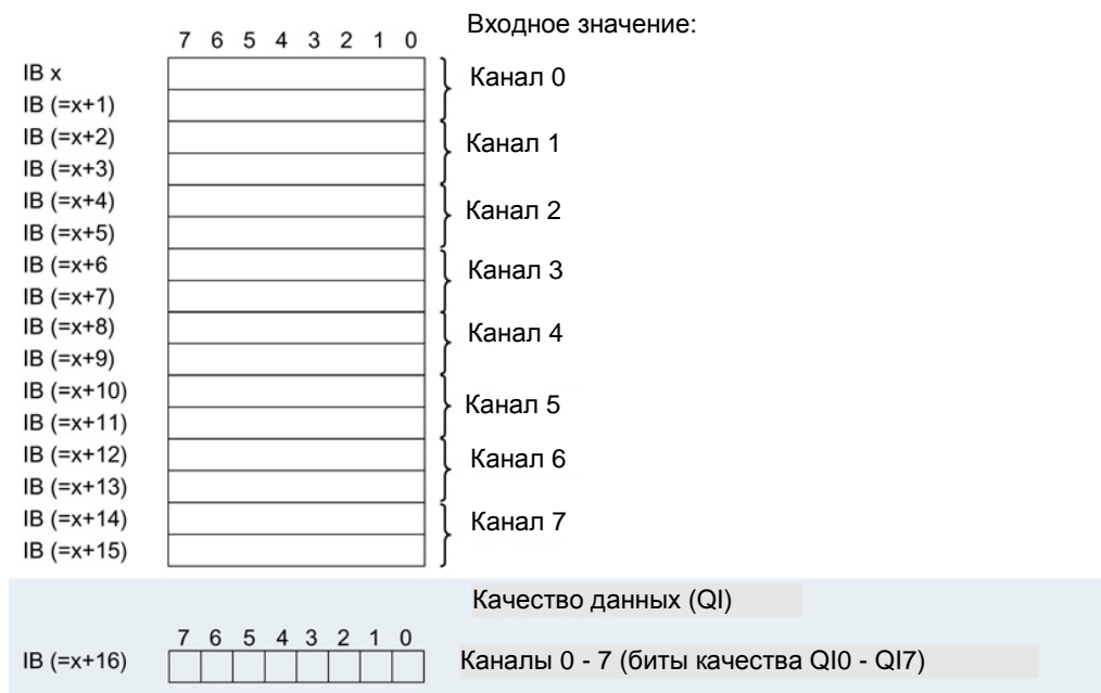
Рисунок 4-2 Адресное пространство модуля AI 8xU/I HS в конфигурации 1 x 8-каналов с регистрацией информации о качестве
