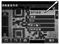
使用顯示畫面最下方的滑桿調整快門速度 也可以按[自動],自動根據影像設定快門速度 和增益
