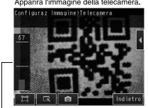
A valore più elevato corrisponde una migliore me Utilizzare la vite di regolazione della messa a fuoco nella parte alta del sensore per mettere a fuoco l'immagine.
