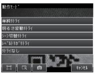
[単純リトライ]、[明るさ変動リトライ]を 選択した場合は、[検査]-[リトライ設定]を タッチして、パラメータを設定します。
