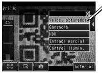
Ajuste la velocidad del obturador con el control deslizante en la parte inferior de la pantalla. También puede presionar [AUTO] para ajustar automáticamente la velocidad del obturador de acuerdo a la imagen.
