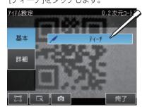
緑の枠内に2次元コードが入っていることを確認して、[TEACH]をタッチします。 計測領域を変更するには[◀]-[計測領域編集]をタッチします
