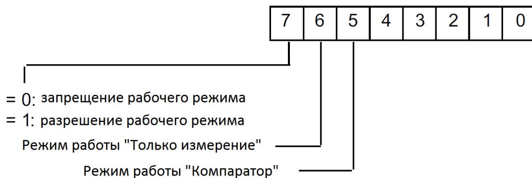
Рисунок 3-4 Значение битов в байте " динамического управления измерительным циклом"
