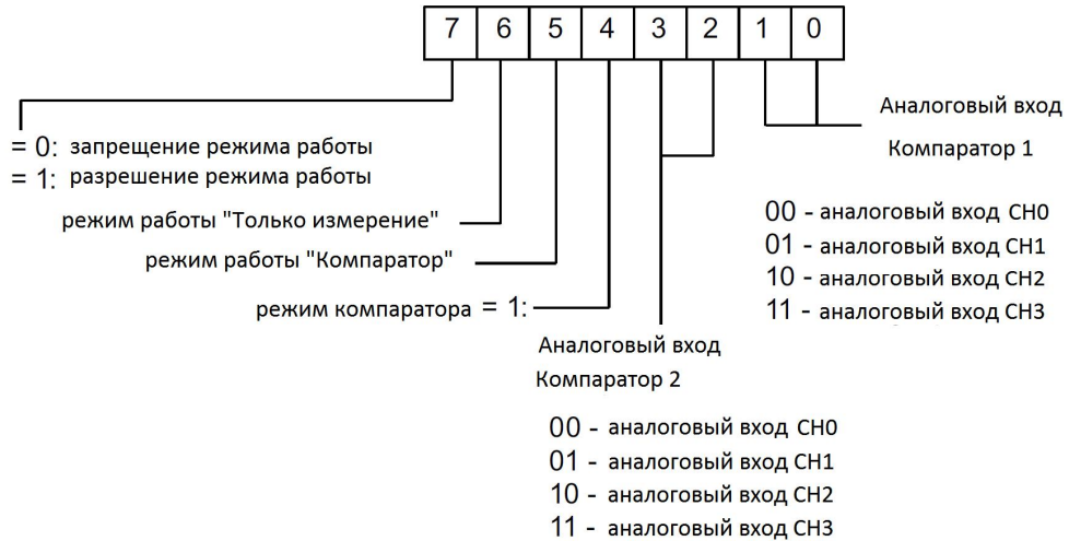
Рисунок 3-6 Назначение битов в байте "динамического управления измерительным циклом"
