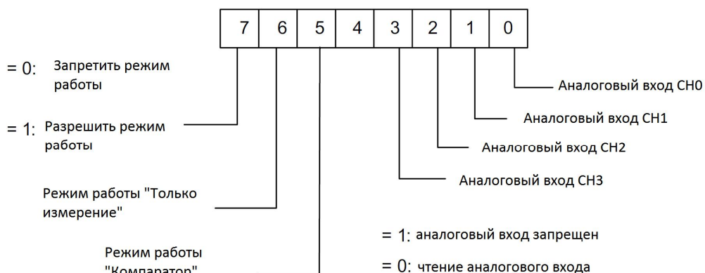
Рисунок 3-9 Значение битов в байте "динамического управления измерительного цикла"
