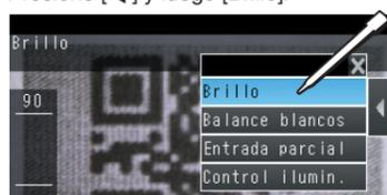
Ajuste el brillo con el control deslizante en la parte inferior de la pantalla. También puede presionar [AUTO] para ajustar automáticamente el brillo de acuerdo a la imagen.
