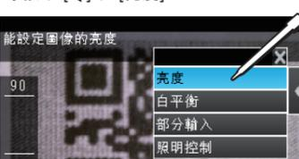
使用顯示畫面最下方的滑桿調整亮度。也可以按 [自動]，自動根據影像設定亮度。
