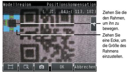
Kontrollieren Sie den Bereich, drücken Sie die [OK]-Taste und drücken Sie die [TEACHEN]-Taste. Damit werden der charakteristische Teil und die Referenzposition des Gegenstands für die Positionskompensation registriert. Drücken Sie auf [Zurück].
