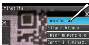
Regolare la luminosità con il cursore di scorrimento nella parte inferiore del display. Si può anche premere [AUTO] per impostare automaticamente la luminosità secondo l'immagine.
