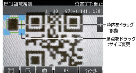
領域を確定後、[OK]ボタンをタッチします。その後、[TEACH]ボタンをタッチします。位置ずれ修正の目印および基準位置として登録されます。
