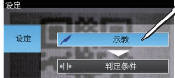
将对象置于照相机前，用作测量参考。移动矩形框，使要“位置补偿”的商标特征位于框内。
