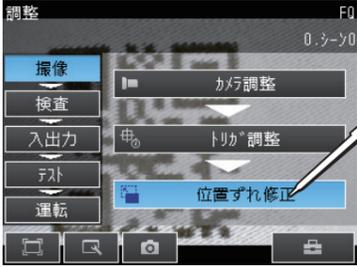
[処理ON/OFF]をタッチし、[ON]に変更します。その後[位置ずれ修正設定]をタッチします。
