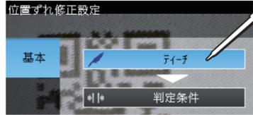
判定の基準となる良品を撮ります。位置ずれ修正の目印にできる特徴部分を囲むように四角形エリアを移動します。
