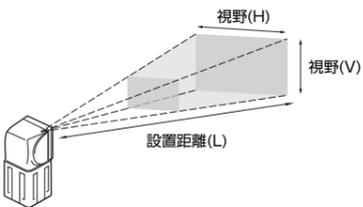
光学図表では、視野(H)を示しています。視野(V)は、視野(H)の約60%になります。
