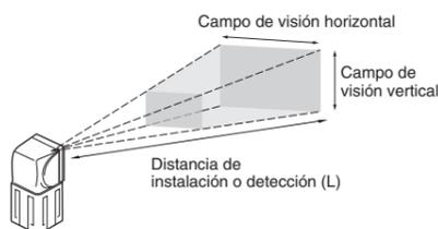
El campo de visión horizontal se indica en el gráfico óptico. El campo de visión vertical es aproximadamente el 60% del campo de visión horizontal.
