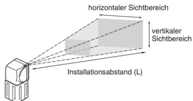
Im Diagramm unten ist der horizontale Sichtbereich in Abhängigkeit vom Installationsabstand dargestellt. Der vertikale Sichtbereich beträgt etwa 60% des horizontalen Sichtbereiches.
