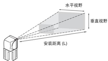
光学图表上会显示水平视野。垂直视野约为水平视野的 60%。
