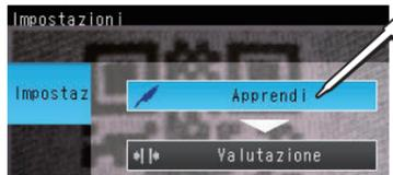
Posizionare di fronte alla fotocamera l'oggetto da utilizzare come riferimento di misurazione. Spostare il rettangolo in modo che la parte caratteristica per la compensazione posizione risulti all'interno di esso.
