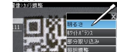
画面下のスライダーで明るさを調整します。[AUTO]をタッチすると、画像に合わせた明るさを自動的に設定できます。
