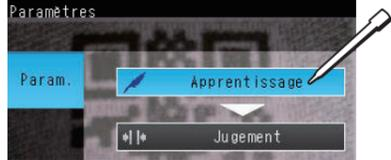
Placez l'objet en face de la caméra qui doit être utilisée comme référence de mesure. Déplacez le rectangle de sorte que la partie caractéristique pour la compensation de position soit à l'intérieur.
