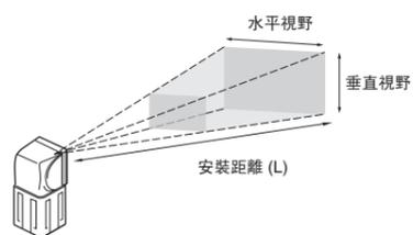
光學圖表上提供水平視野。垂直視野大約是水平視野的 60%。
