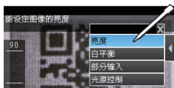
使用显示界面下方的滑块调整亮度。还可以按 [自动], 自动根据图像自动设定亮度。
