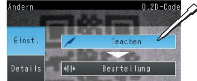
Stellen Sie sicher, dass sich der 2D-Code im grünen Rahmen befindet, und drücken Sie auf [OK].
