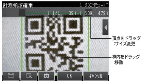
ティーチをタッチします。読取成功の場合、2次元コードの種類と検出文字数が表示されます。
